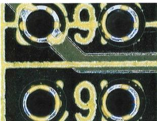
Mit Bezeichnungsdruck bedeckte Lötäugen. Die Bezeichnung ist unlesbar, bei der Lötqualität sind erhebliche Einbussen zu erwarten. Eine solche Ausführung ist nicht zulässig.
